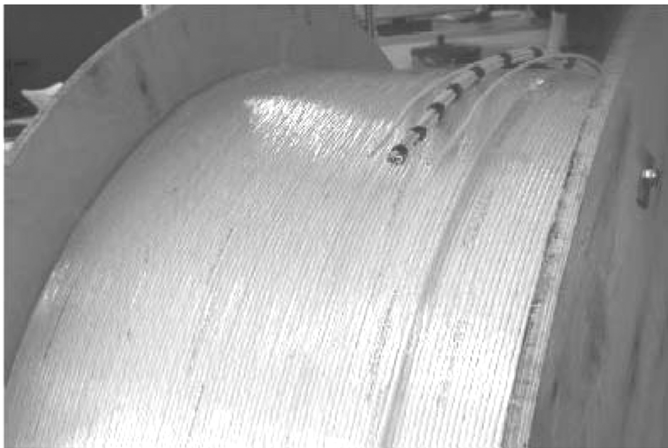
Рисунок 16 — Схема укладки кабелей на барабане
